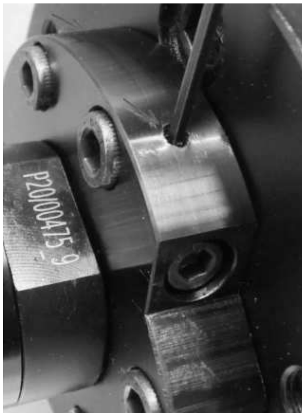
15) Serrare i grani di bloccaggio bussola
